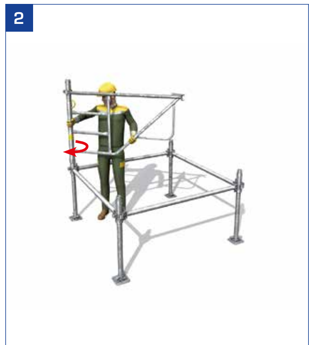
- Den ersten Rahmen vom Inneren des Turms aus in der Achse der Diagonale einsetzen und dann zum Verriegeln drehen.
