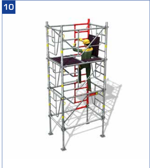
- Die erste Belagebene kann nun entfernt werden. Zugang zu der oberen Ebene über die integrierte Leiter.
