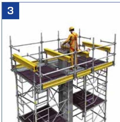
- Die Durchstiegselemente hochheben. Der Gerüstbauer muss ein Sturzsicherungssystem verwenden, solange die Betonträger nicht eingesetzt sind.
