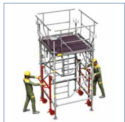
8 - Oder umsetzung mit Umsetzwagen.
